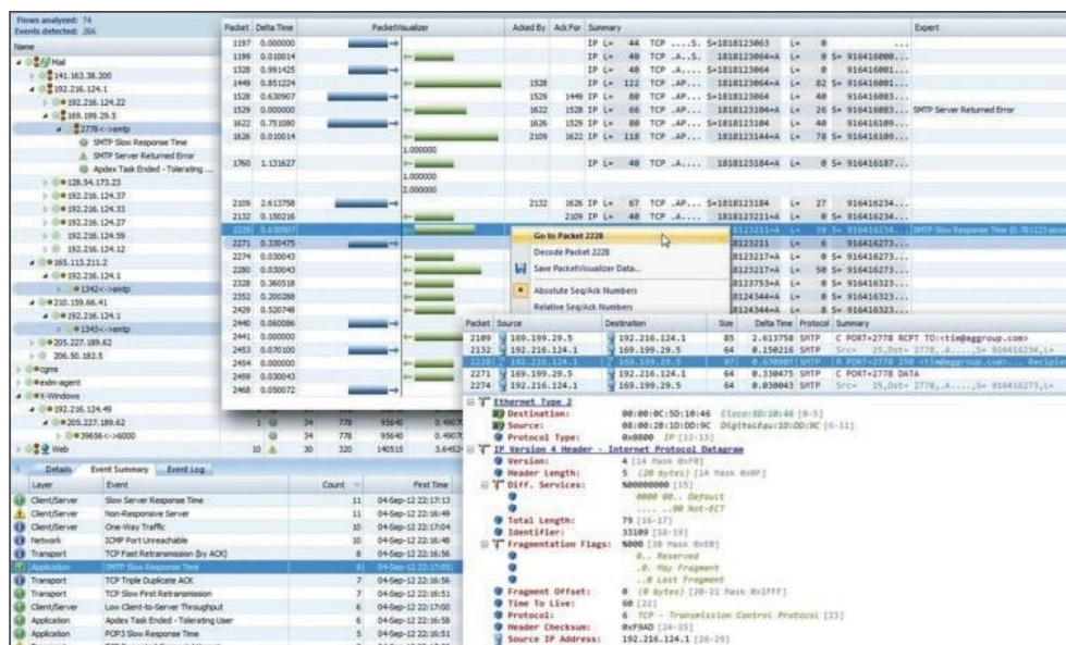
Der Troubleshooting-Prozess auf einen Blick: Vom Expert Event zum betroffenen Flow, in den betroffenen Flow (Packet Visualizer) und von hier zu den relevanten Paketen:
