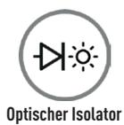
Secure Fiber-TAPs besitzen sowohl einen zusätzlichen optischen Isolator (Datendioden-Funktionalität), als auch einen optischen Filter die sicherstellen, daß unerwünscht einfallende Lichtsignale am Monitoring-Port blockiert werden, um das Netzwerk vor Kompromitierung zu schützen.
